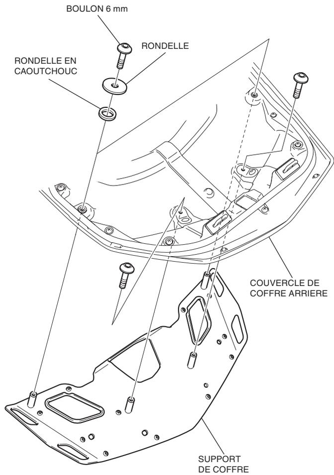
44. Montez le couvercle de coffre arrière dans l'ordre inverse de la dépose.
