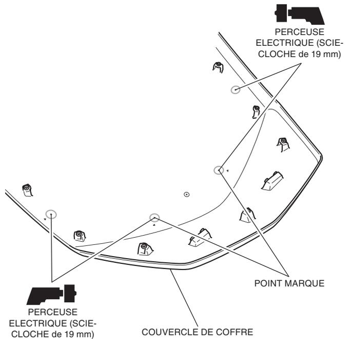
PERCEUSE ELECTRIQUE (SCIE-CLOCHE de 19 mm)
