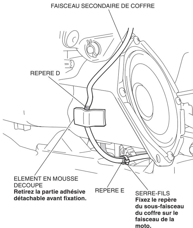
31. Installez les différentes pièces de la moto dans l'ordre inverse de leur dépose.
