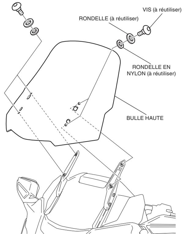
6. Installez les différentes pièces de la moto dans l'ordre inverse de leur dépose.
