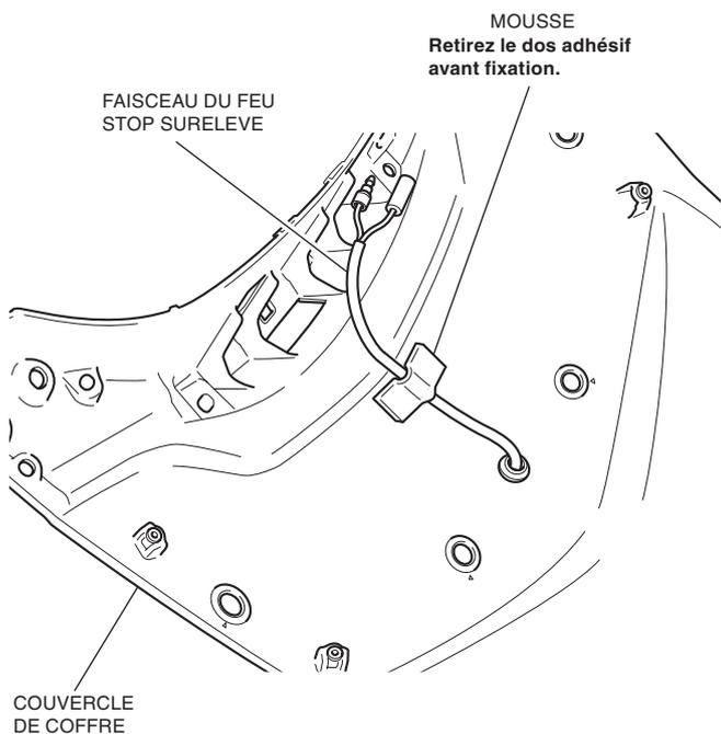
31. Exécutez les étapes 19 à 22 sur le faisceau secondaire de coffre (vendu séparément) conformément aux instructions d'installation.
